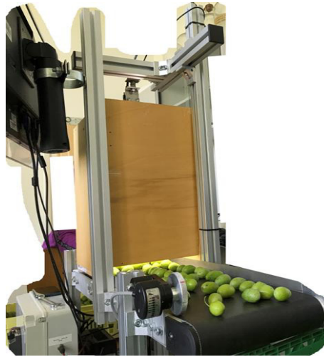
Figura 4: Sistema optoelettronico banco traslante con una camera RGB [Mako con sensore di tipo CMOS e risoluzione 1456 (H) × 1088 (V)] durante l’acquisizione delle immagini delle olive della cultivar “Bella di Cerignola”.
